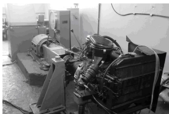
Рисунок 2 – Общий вид экспериментальной моторной установки
