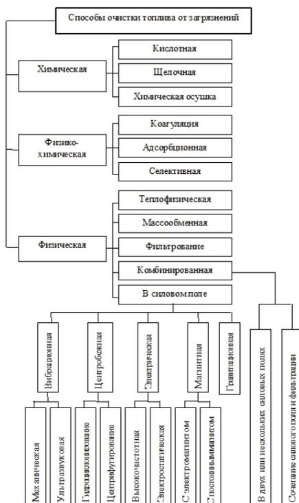
**Рисунок 1 - Классификация способов очистки топлива**
