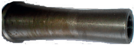
Рис. 4 – Профилированное сопло деемульгатора
