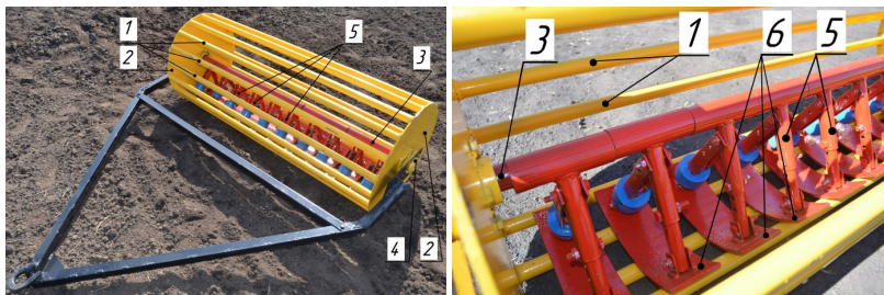
1 – планки; 2 – диски; 3 – ось; 4 – крепления сцепки; 5 – поводки; 6 – молотки Рисунок 2 – Планчато-молотковый почвообрабатывающий каток
