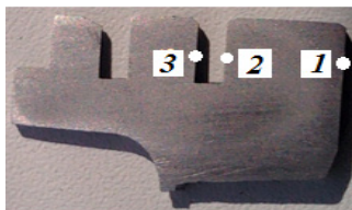
Рисунок 1 – Шлиф фрагмента оксидированного поршня с указанием точек измерения микротвердости
