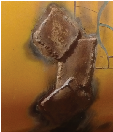
Рисунок 1 – Поверхность автоцистерны после заварки трещины
