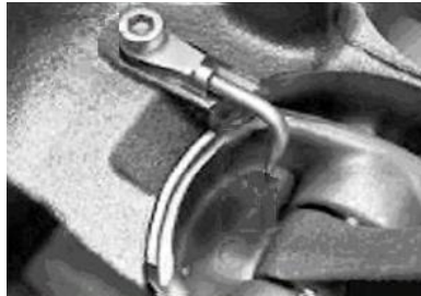
Рисунок 1 - Форсунка в нижней части гильзы цилиндра
